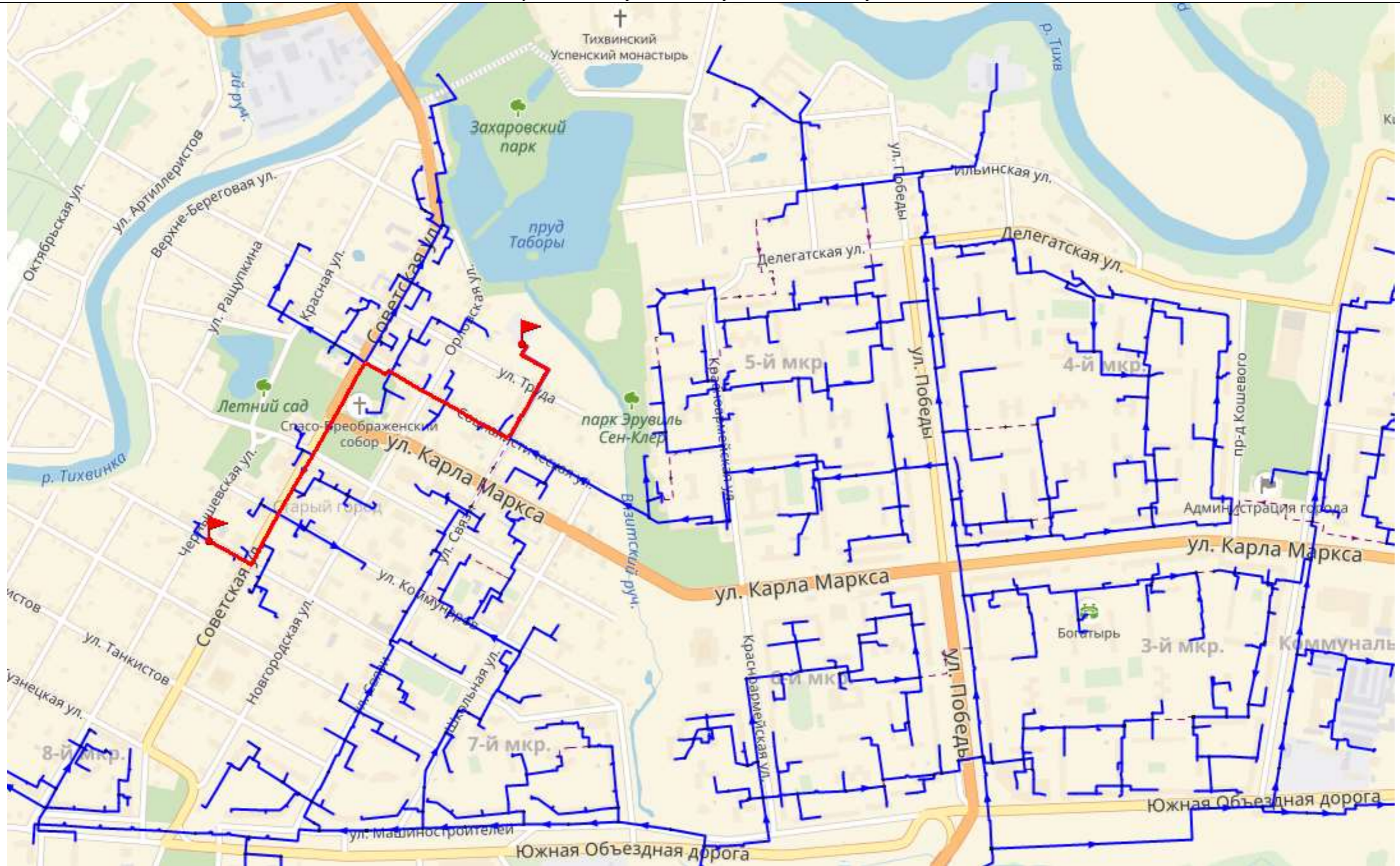
Рисунок 30. Путь построения пьезометрического графика от ЦТП «Старый город» до К-4 (Знаменская ул.)
