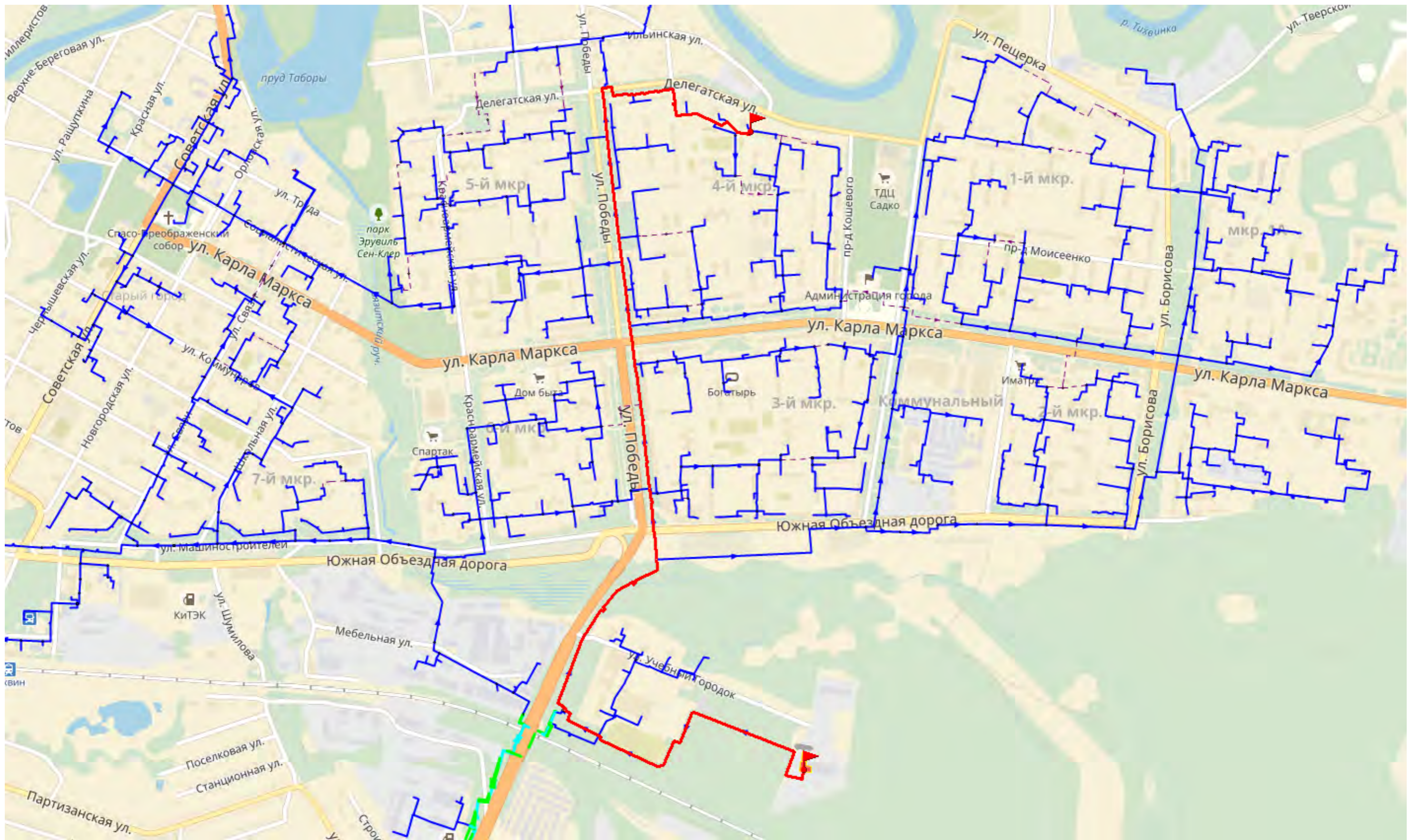
Рисунок 20. Путь построения пьезометрического графика от Новой котельной до К-17/3 (4 микрорайон)
