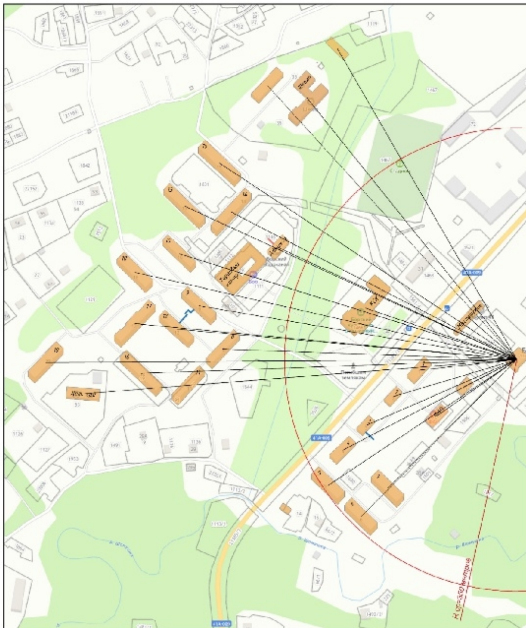
Рисунок 14 – Зона действия и радиус централизованного теплоснабжения котельной д. Бор
